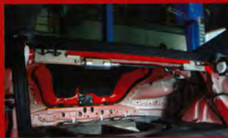
リヤはシートを外したクロスメンバーのアップバー側に、フロント同様に専用ブラケットを使い装着
