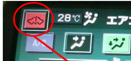
整備モード移行時に表示されます (車両により画面表示が異なります)
