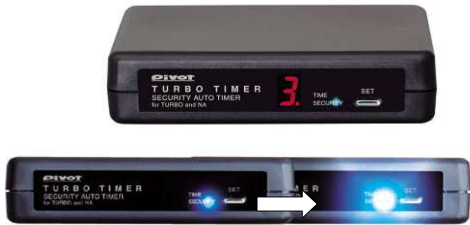
振動を感知すると・・・強力発光での高速点滅に一定時間切り替わります
